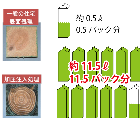
図5 薬剤の浸透の様子と薬剤の浸透量
