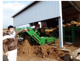
写真2 自動選別機(丸太を送る部分)
