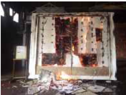
写真 5.2-29 脱炉直後の加熱面
