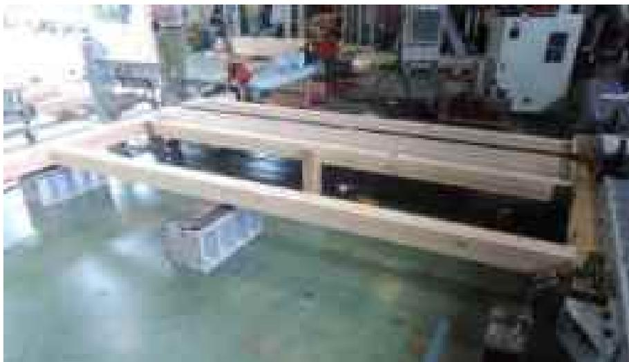
写真 2.2-3 試験体設置状況（試験体下部ローラー）
