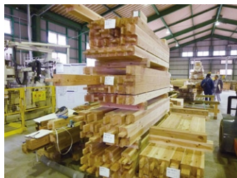
写真4 仕口加工した材に邸別のラベル
