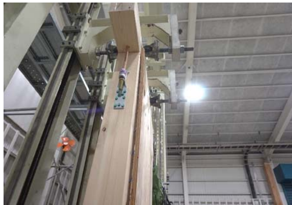
くぎの引抜け
