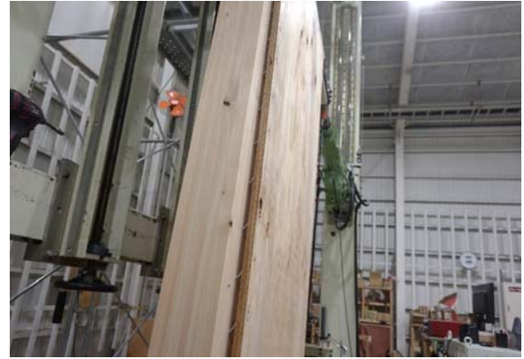
くぎの引抜け
