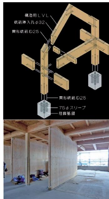
上/RH工法の接合部の構造
