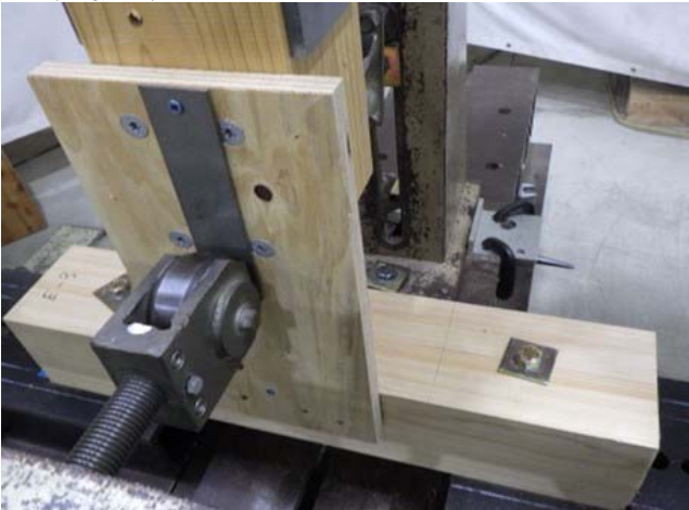
写真-14 「3-S_Wh18-75_⊥(単) 試験終了後」
