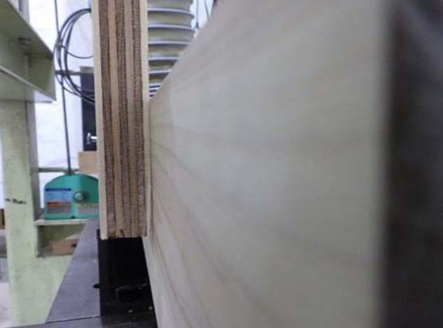
写真-28 「6-S_Ws24-75_⊥ (繰) 試験終了後」
