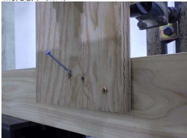
写真-8 「2-S_Wk18-75_⊥ (繰) 試験終了後」
