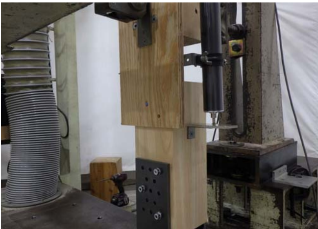
写真-2 【繊維平行方向】試験体設置状況
