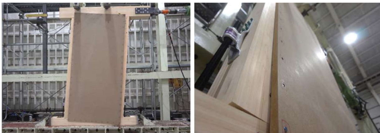
図 4-13 破壊時写真例 (1 体目)
