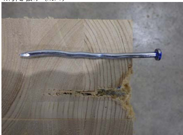
写真-10 「2-S_Wk18-75_⊥ (繰) 解体後」
