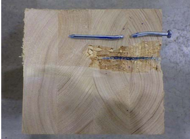
写真-21 「4-S_Wh18-75_⊥ (緑) 解体後」
