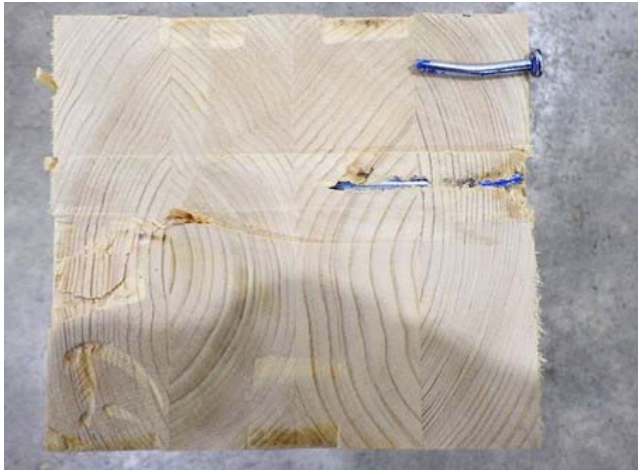
写真-49 「10-S_P18-75_⊥ (繰) 解体後」
