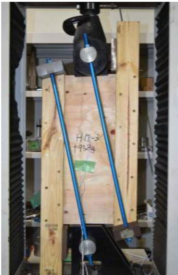
図 7.6 厚さ 18mmPly-H 破壊性状
