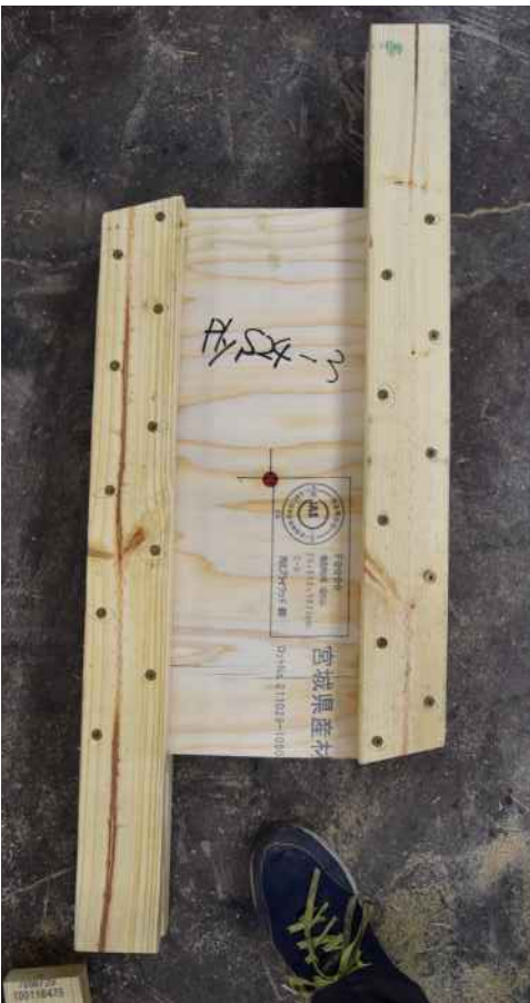
図 7.9 厚さ 24mmPly-S 破壊性状
