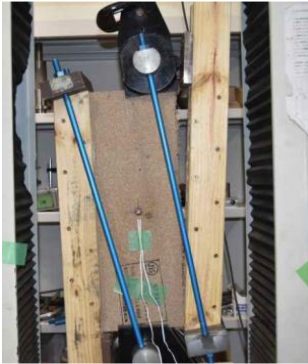
図 7.1 厚さ 9mmPB 破壊性状
