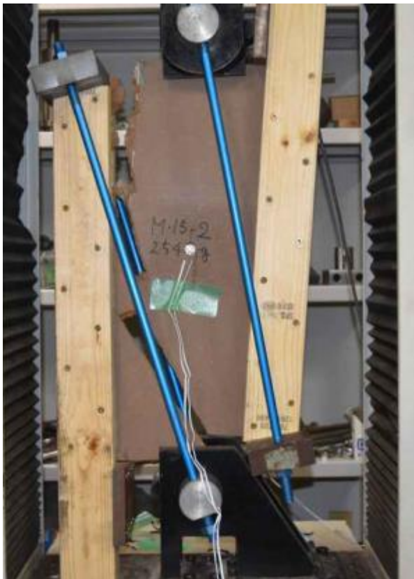
図 7.3 厚さ 15mmMDF 破壊性状
