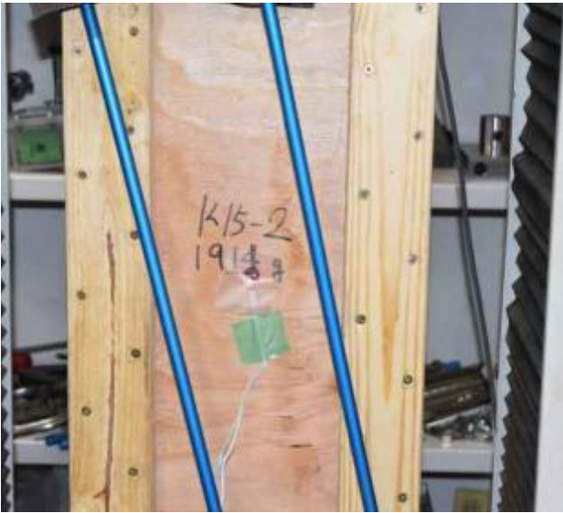
図 7.7 厚さ 15mmPly-K 破壊性状
