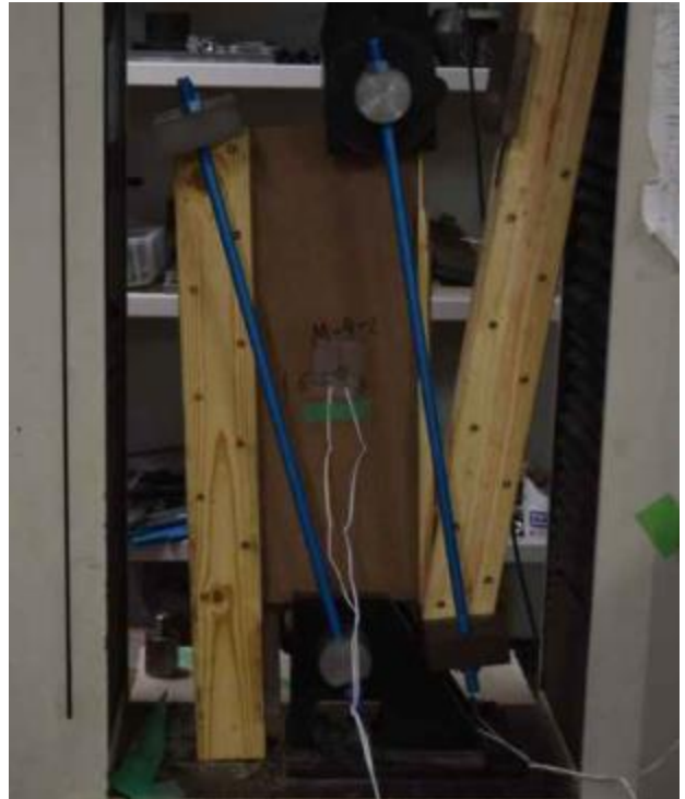
図 7.2 厚さ 9mmMDF 破壊性状
