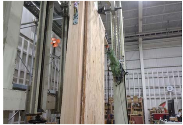
くぎの引抜け
