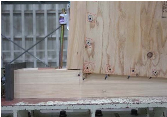
面材の縁切れ、くぎの引抜け
