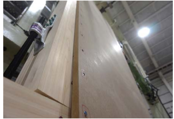
くぎの引抜け
