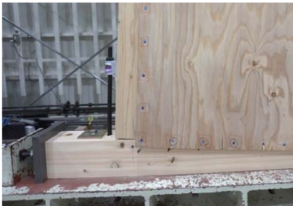
くぎの引抜け
