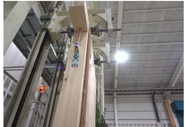
くぎの引抜け
