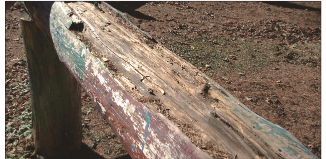
写真3 カラマツの丸太で製作した遊具 辺材のみ腐朽している。(製作8年経過時)
