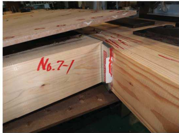
加力側の柱頭部(めりこみ破壊)
