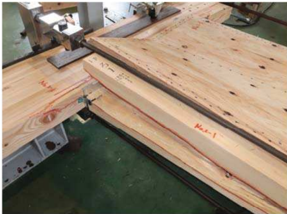
反加力側の柱頭部(柱の割裂破壊)
