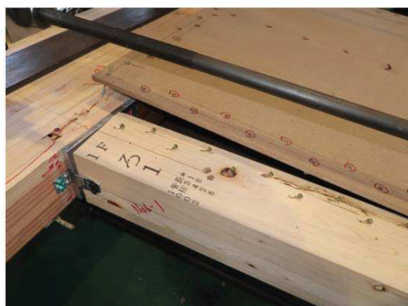
反加力側の柱頭部(面材のパンチングアウト)
