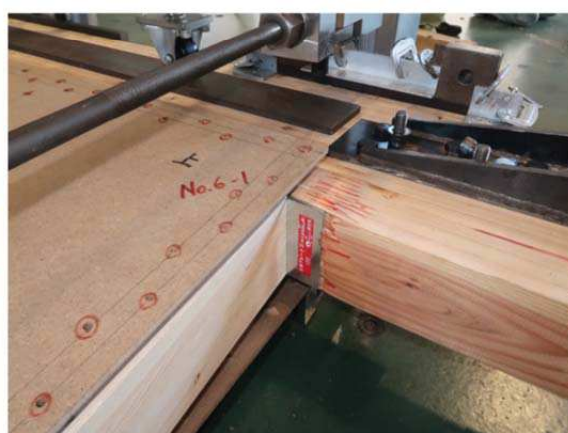
加力側の柱頭部(めりこみ破壊)
