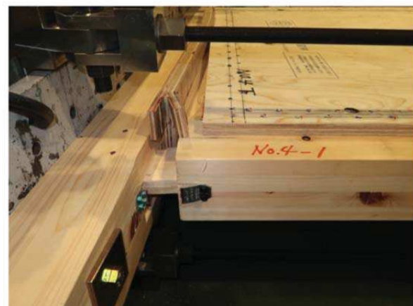
加力側の柱脚部(柱の引き抜け)
