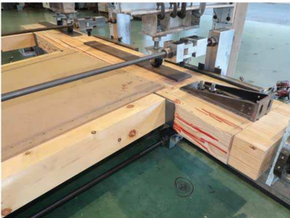
試験体の上部(めりこみ破壊)
