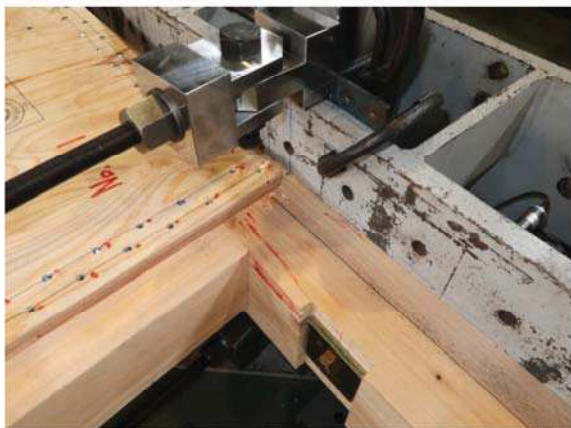
反加力側の柱脚部
