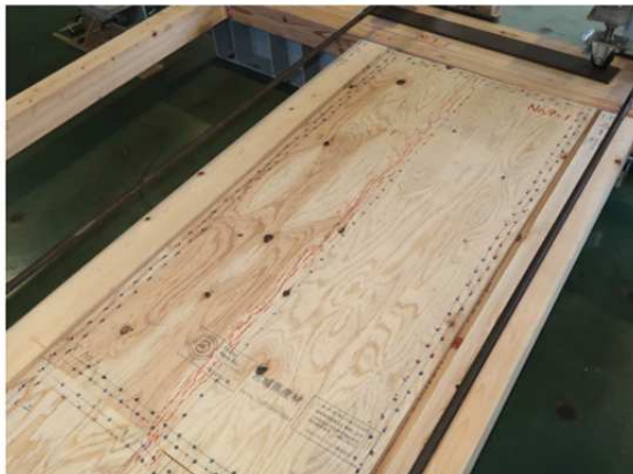
上側の面材(面材のせん断破壊)
