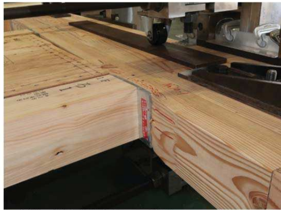
加力側の柱頭部(めりこみ破壊)
