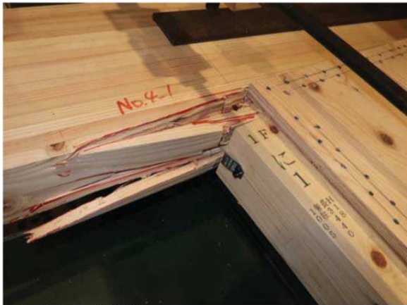
反加力側の柱頭部
