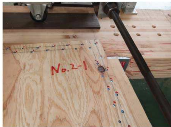
加力側の柱頭部(めりこみ破壊)
