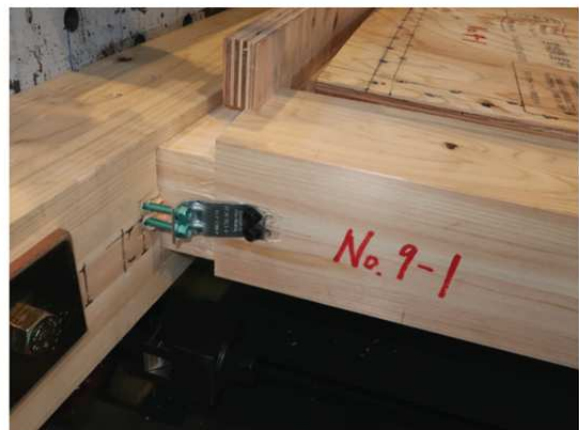
加力側の柱脚部(柱の引き抜け)
