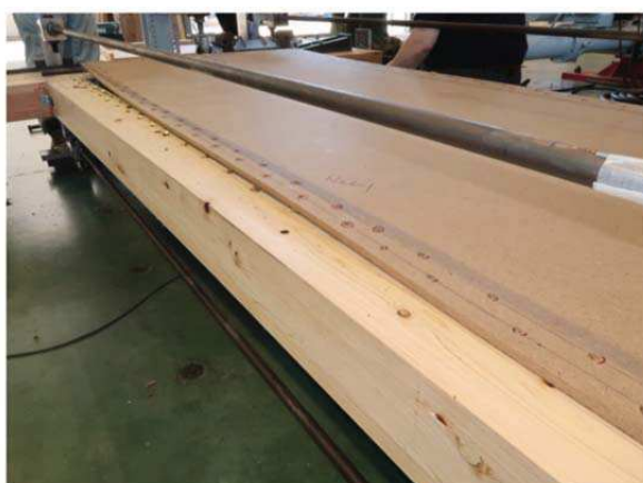
反加力側の柱(面材のパンチングアウト)
