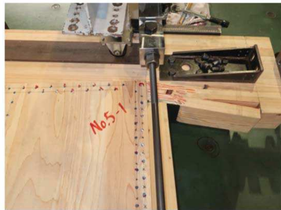
加力側の柱頭部(めりこみ破壊)
