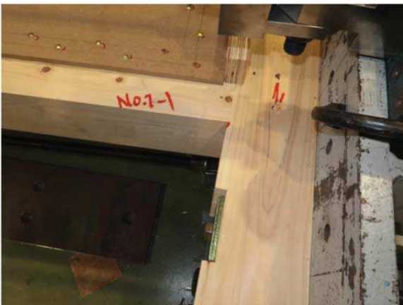
反加力側の柱脚部
