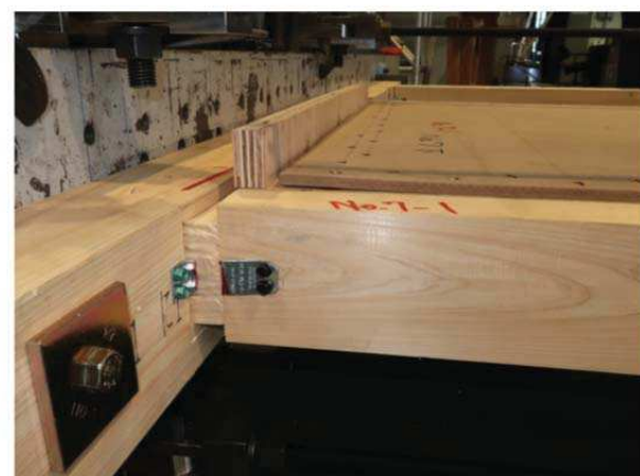
加力側の柱脚部(柱の引き抜け)
