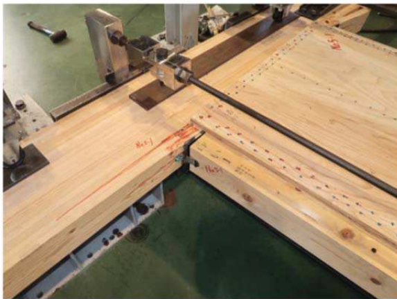
反加力側の柱頭部
