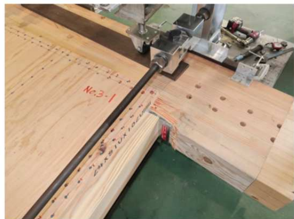
加力側の柱頭部(めりこみ破壊)
