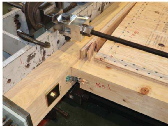
加力側の柱脚部(柱の引き抜け)
