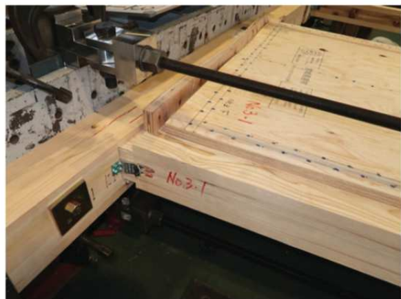
加力側の柱脚部(柱の引き抜け)
