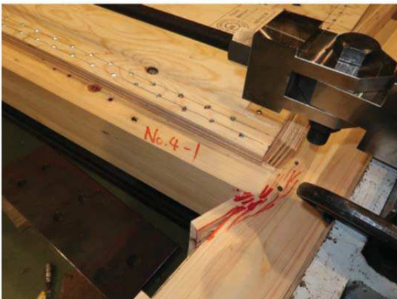
反加力側の柱脚部
