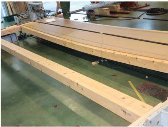
耐力壁の両側の柱とも曲げ変形
