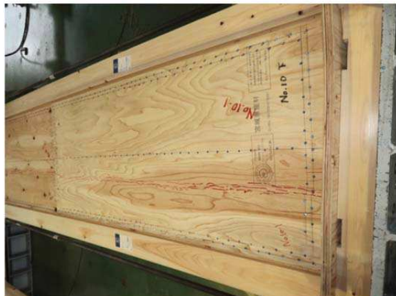
下側の面材(面材のせん断破壊)
