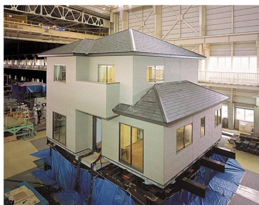
写真7 現代的住宅の振動台実験
