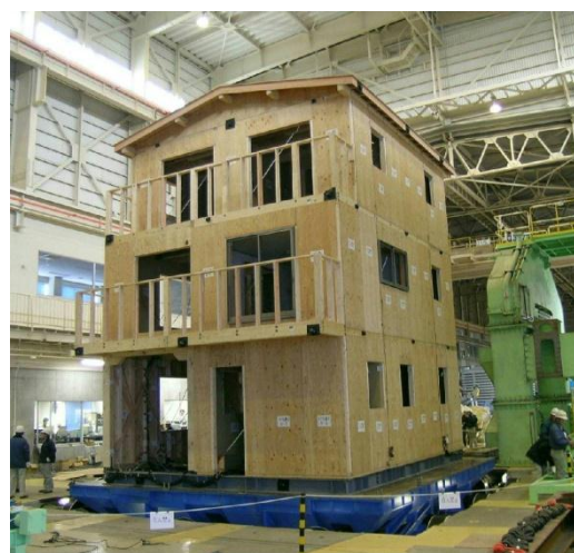
写真8 3階建て住宅の振動台実験
