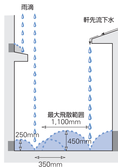
図2 跳ね返り雨水による壁面足元の濡れ (引用:石川廣三:雨仕舞のしくみ 基本と応用、彰国社、p.101、2004 より作図)
