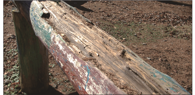
写真3 カラマツの丸太で製作した遊具 辺材のみ腐朽している。(製作8年経過時)
